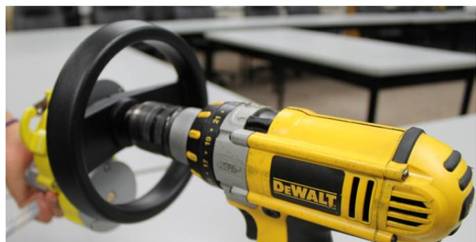
El eje de 10 mm de diámetro que sobresale del volante sirve como adaptador para el taladro. Conecte el taladro para ayudar a controlar el ascenso de la persona rescatada. Par mínimo recomendado: 45 nm. Velocidad mínima de rotación: 0-300 rpm.
